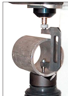
C型压头支架用于测量工件内部不同位置硬度。
